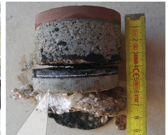
Bohrkern Bodenaufbau mit asbesthaltiger Estrichschicht, Abdichtung
